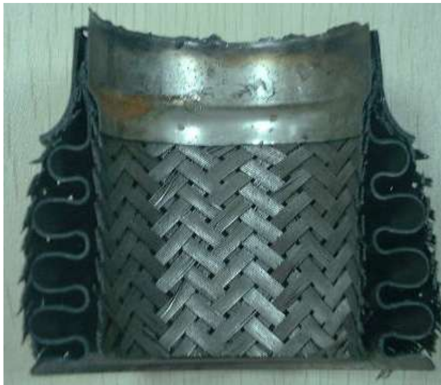
Продукция Bosal после теста на высокую температуру( 700°C)
