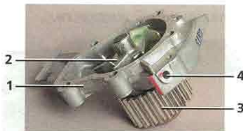
Насос охлаждающей жидкости: 1 — корпус; 2 — крыльчатка; 3 — шкив; 4 — контрольное отверстие
